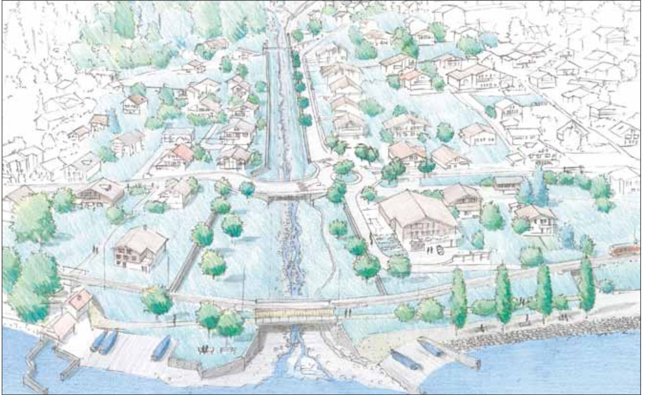
So wird sich die Glyssibach-Verbauung von der Mündung bis zum Schalenkopf dereinst präsentieren (Gesamtansicht der Situation nach Abschluss der Bauarbeiten, Zeichnung Moeri & Partner).
